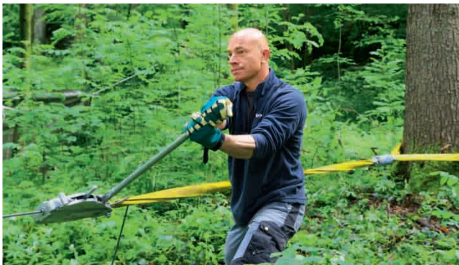
Matthias Scheiwiller aus Davos am Prüfstand mit dem Seilzug Habegger Hit 10.
