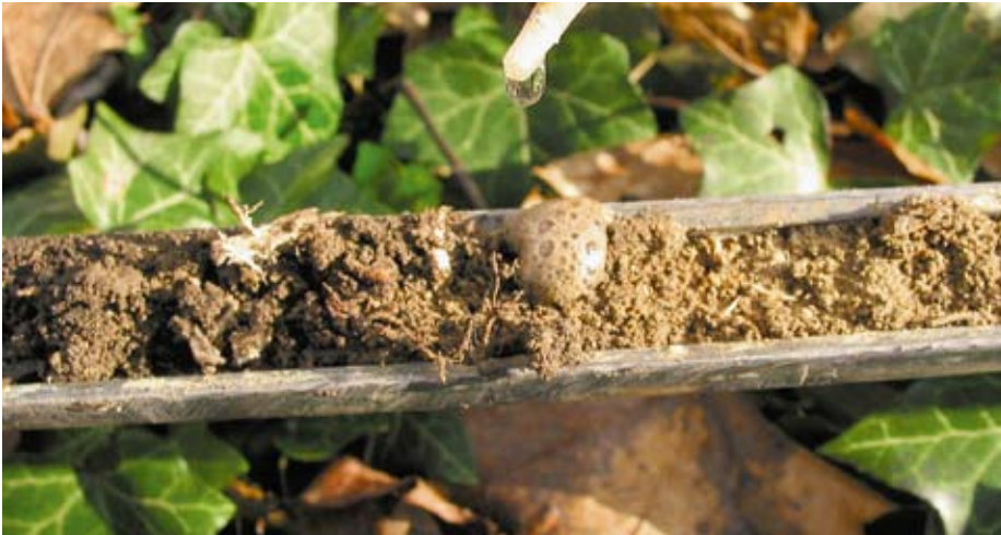
Salzsäuretest zur Karbonatbestimmung im Mineralboden.
